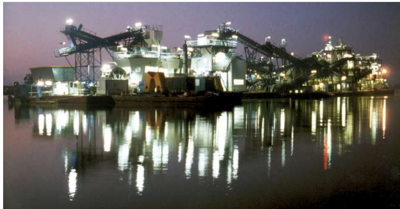
Das Prunkstück der Smals-Gruppe: die Schwimmende Sandaufbereitungsanlage Vierlingsbeek bei Cuijk in der Nähe von Nimwegen | Bild: Smals
