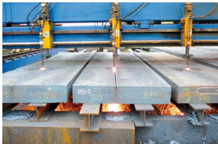
Die 15-strahlige Brennschneidanlage verarbeitet Stahlbrammen in kundengerechte Abmessungen | Bild: Weiler GmbH
