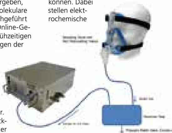
Vorrichtung zur molekularen Gasanalyse der Atemluft
