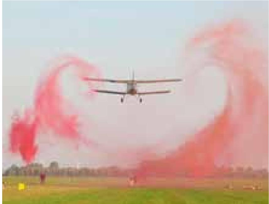
Sichtbarmachung des Wirbelaufrollens nach AN-2-Bodenüberflug
