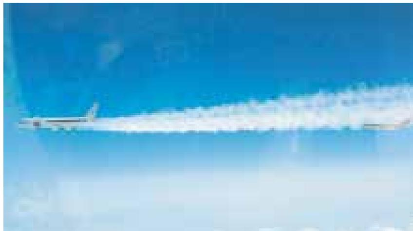
Partikel- und Spurengasmessungen des DLR-Instituts für Physik der Atmosphäre an Bord der Falcon-20 im Abgasstrahl und Kondensstreifen der NASA DC-8 bei Verwendung eines Biotreibstoffs im Luftraum der Edwards Air Force Base in Kalifornien (Foto: NASA).
