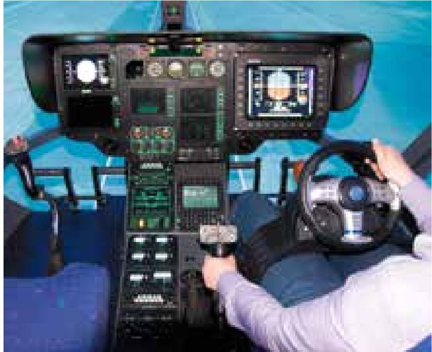
Lenkradsteuerung im Hubschraubersimulator AVES
