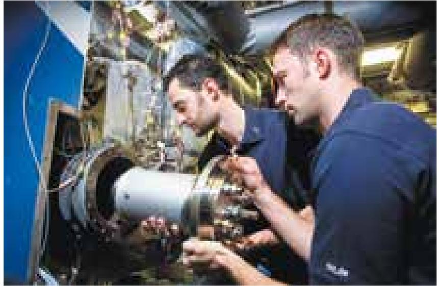
Einbau des Holzgas-FLOX®-Brennkammersystems in die Mikrogasturbine Turbec T100
