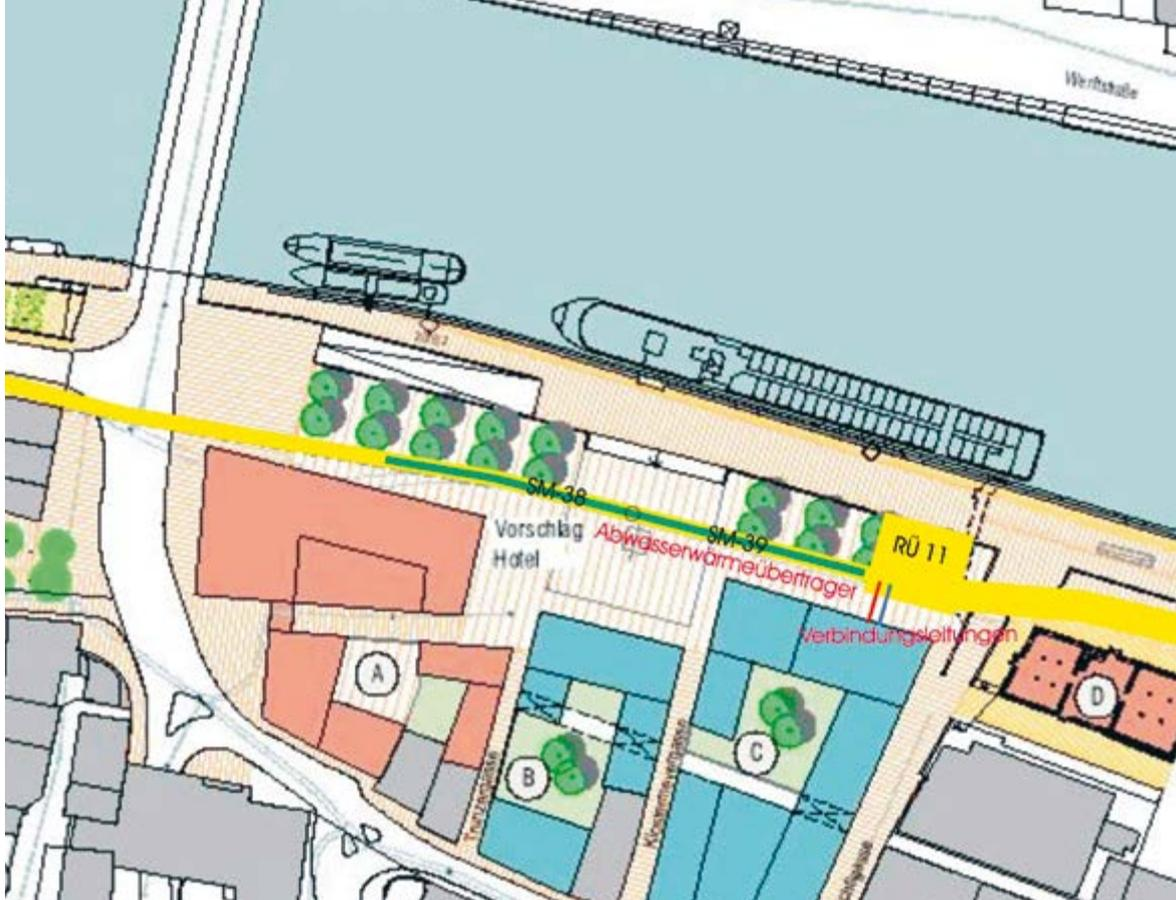
Lageplan Wärmeübertrager und mögliche Trasse der Verbindungsleitung
