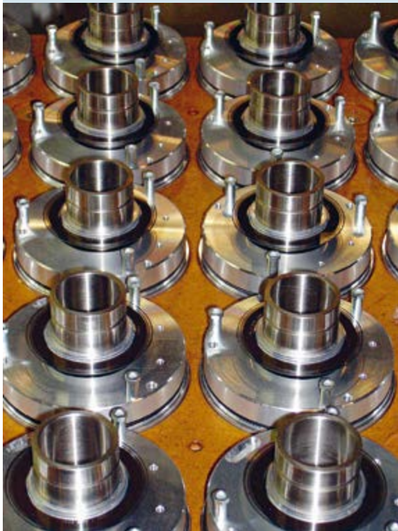
Drehgeber der Fa. Baumer Thalheim – Einsatz u. a. in Windkraftanlagen
