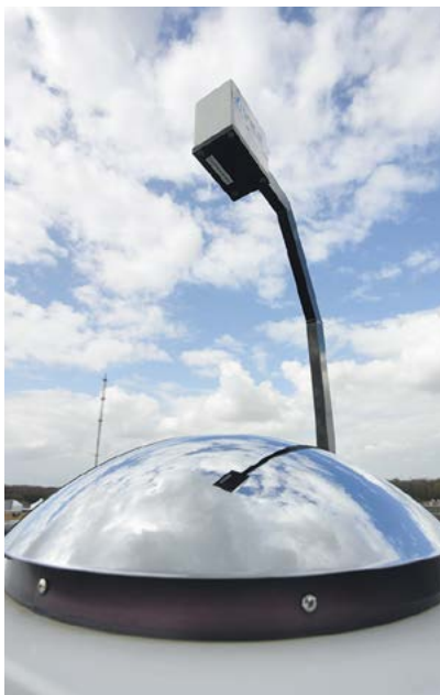
Der „Total Sky Imager“ erfasst das Ausmaß, in dem der Himmel mit Wolken bedeckt ist.
