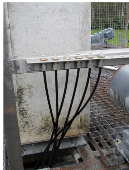
*Bild: erneuerte Steuerungstechnik und Umbau auf Zentralschmierung zur Minimierung der Wartung (Eigenleistung)*
