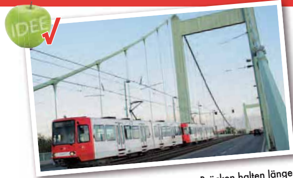
Metallschwellen auf vielbefahrenen Brücken halten länger und der Verkehr kann ohne Unterbrechung rollen.
