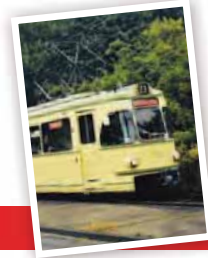
Flott und geräumig: der erste vierachsige Großraumtriebwagen. 30 Sitzplätze, 78 Stehplätze und Geschwindigkeiten bis zu 70 km/h! 1956
