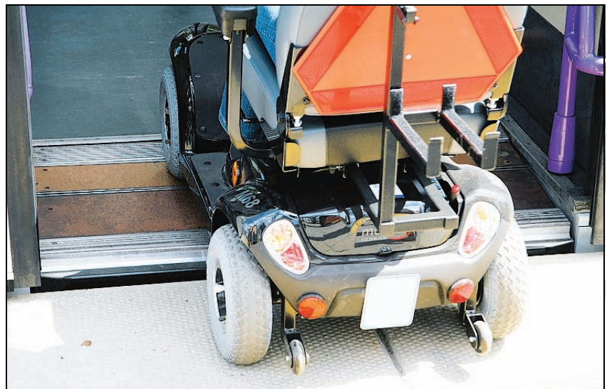
Dank der schräg eingebauten Trittstufe bereitete das Einfahren in die Stadtbahnwagen den Rollstuhlfahrern keine Probleme mehr.
