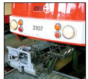
Die Wagen der Serie 2100 (oben) sollen schwenkbare Kupplungen (unten) erhalten.
