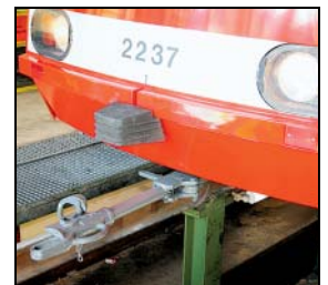
Die Wagen der Serie 2100 (oben) sollen schwenkbare Kupplungen (unten) erhalten.
