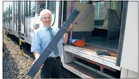
Hilfe für Rollstuhlfahrer: Die Außenschwelle überbrückt nun den Spalt zwischen Bahnsteigkante und Türschwelle der KVB-Züge.
