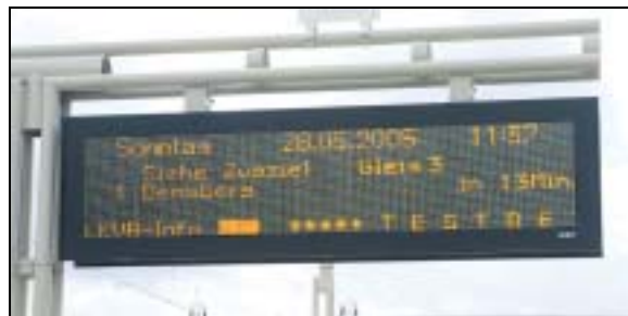
Strahlend gelbe, hellere und deutlichere Schrift kennzeichnet die neue Generation von Informationsanzeigern an den Haltestellen.
