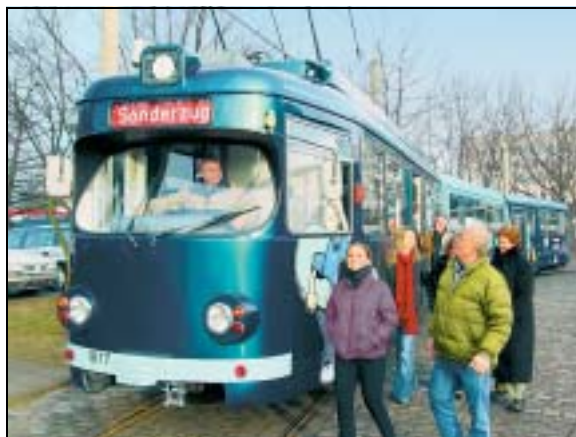
Effekt-Lackierung macht den Colonia-Express zum Chamäleon: Er reagiert mit Farbänderung auf unterschiedlich starke Sonneneinstrahlung.
