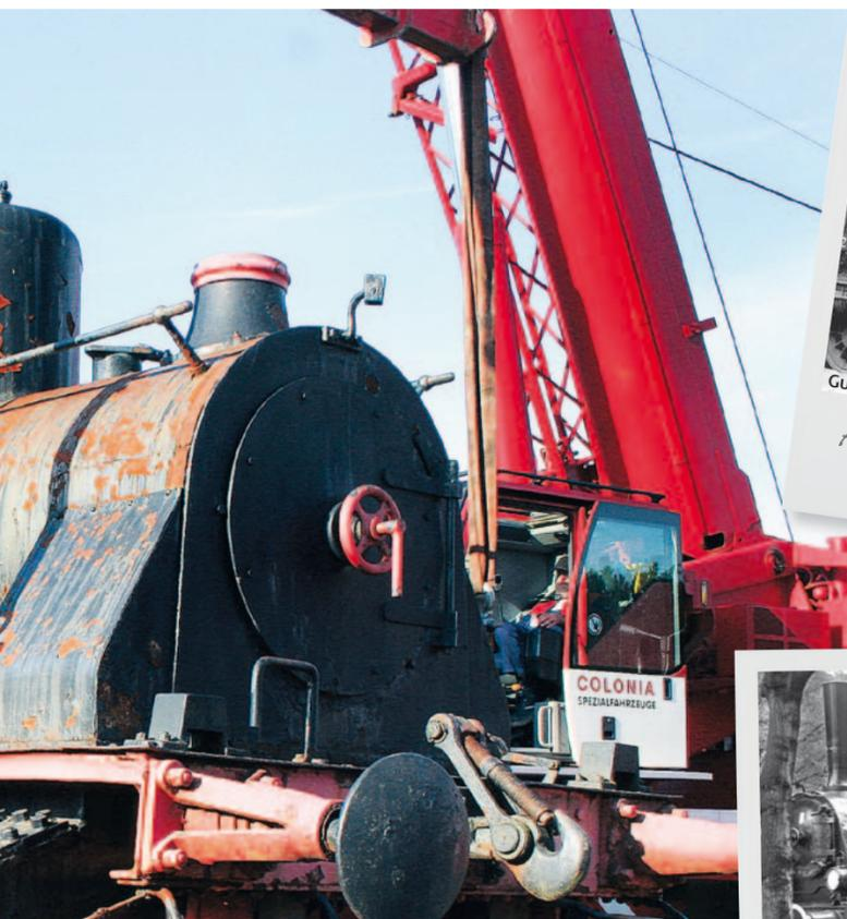
ist, wird restauriert, schließlich soll die Lok so authentisch wie möglich erscheinen“, erzählt er. Verwendet werden unter anderem der ursprüngliche Sanddom – in diesem Behälter wurde der zum Bremsen benötigte Sand aufbewahrt – und die originalen Fensterrahmen.
