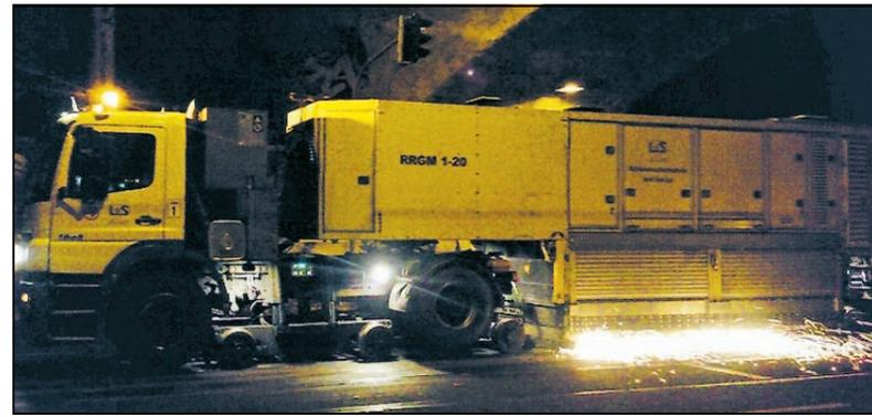
In den Nachtstunden ist diese Spezialmaschine unterwegs, um die Schienen der KVB zu schleifen.
