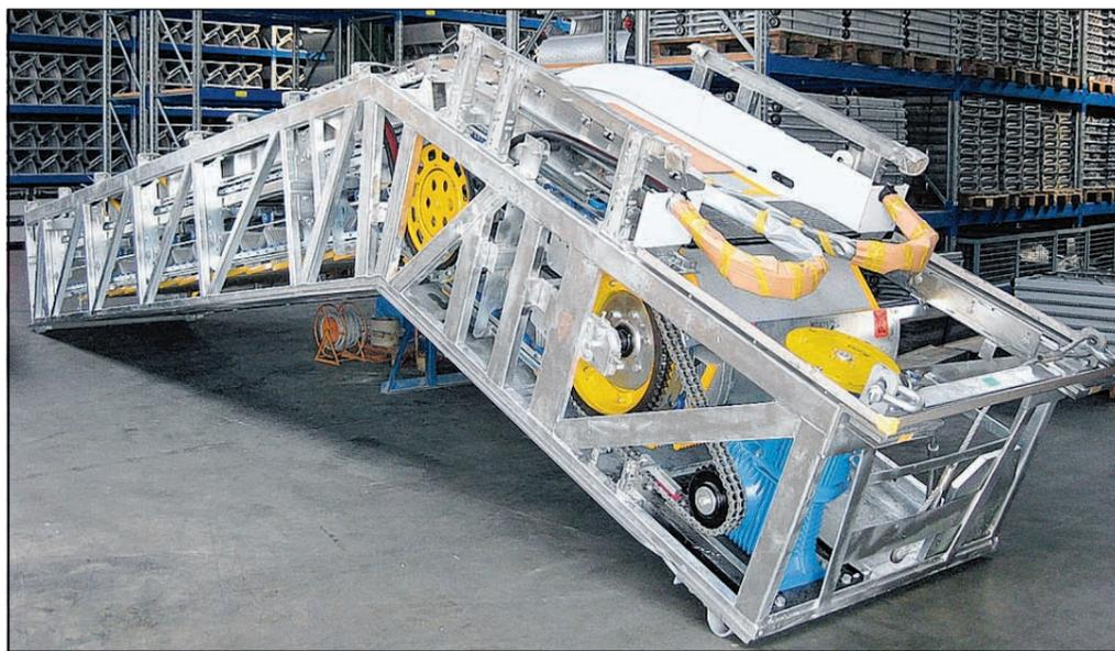
Eine Fahrtreppe im „Rohbau“ wartet im Longericher Lager der Firma Geysssel auf ihren Aufbau und die Montage in einer der Kölner U-Bahnstationen.
