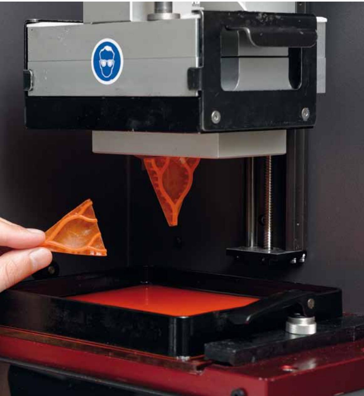
Bild 2: Generative Fertigung von Blutgefäßmodellen durch Photopolymerisation.
