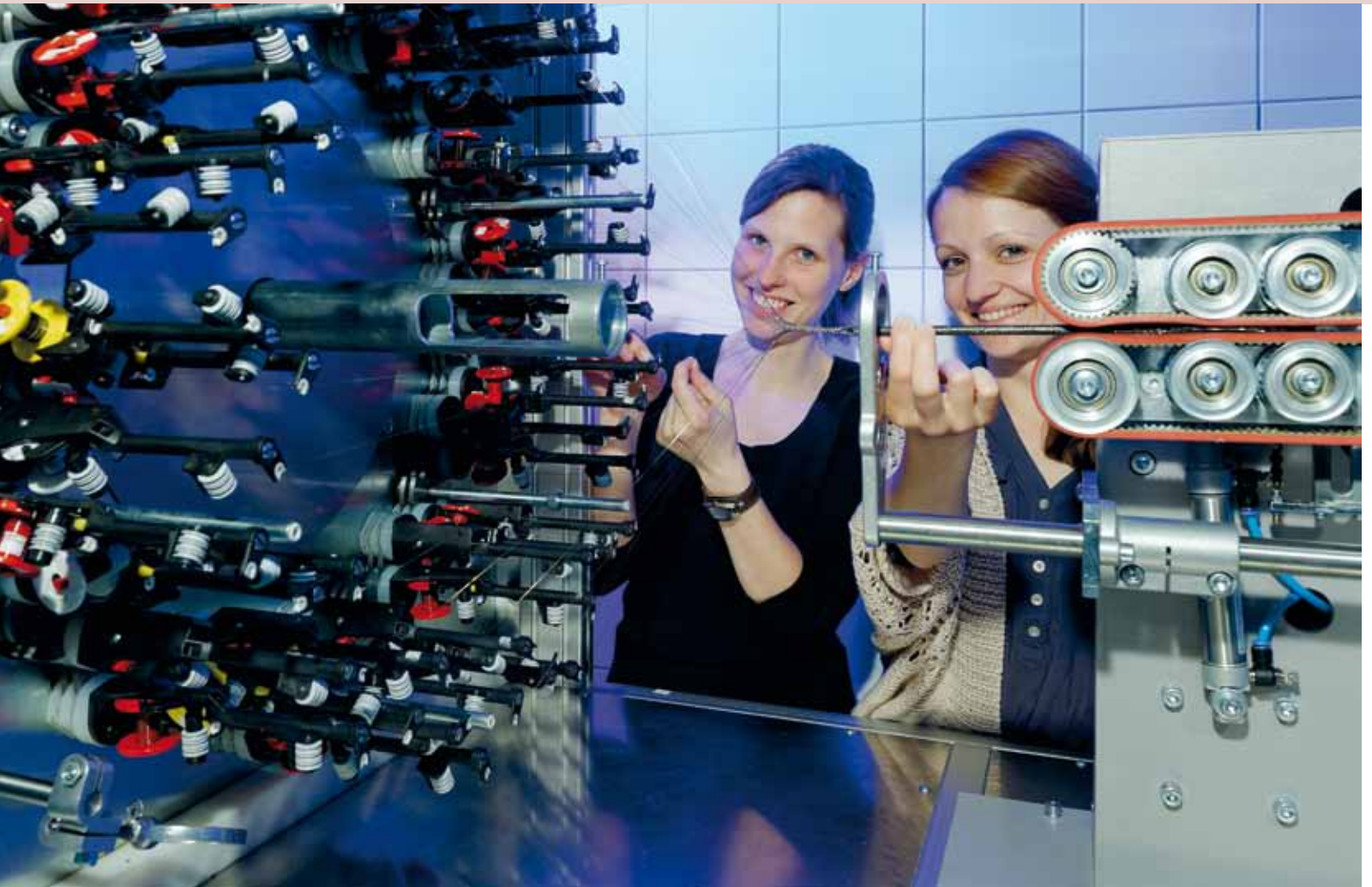
Bild 1: Einrüsten einer Flechtmaschine zur Herstellung einer tabulären Flechtstruktur. Foto: Peter Winandy
