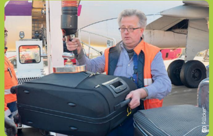
**V**ollgepackte Koffer in ein Flugzeug zu verladen ist schwere körperliche Arbeit. Um seine Mitarbeiter vor langfristigen Folgeschäden zu bewahren, tut der Airport jedoch sein Bestes – und wird sogar erfinderisch. Mitarbeiter der Abteilung Geräte- und Fahrzeugtechnik konstruierten ein Förderband mit integrierter Hebehilfe, die das Gepäck mit Unterdruck anhebt und so ohne Kraftaufwand vom Kofferwagen aufs Förderband bewegt werden kann.
