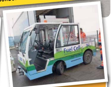
**Wasserstoffantrieb:** Der Airport beteiligt sich an der Entwicklung von zukunftsweisenden Technologien. Im Frühjahr und im Sommer war am Flughafen für jeweils mehrere Wochen ein Gepäckschlepper mit Wasserstoffantrieb zu Testzwecken im Einsatz. Wasserstoff ist ein nicht-endlicher Rohstoff, bei dessen Verbrennung kein CO<sub>2</sub> entsteht.
