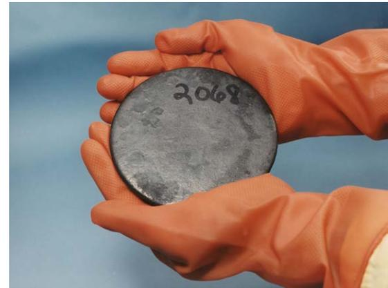
Sogenannter Stangenabschnitt aus hochangereichertem Uran (Foto: Wikipedia Commons / HEUranium)
