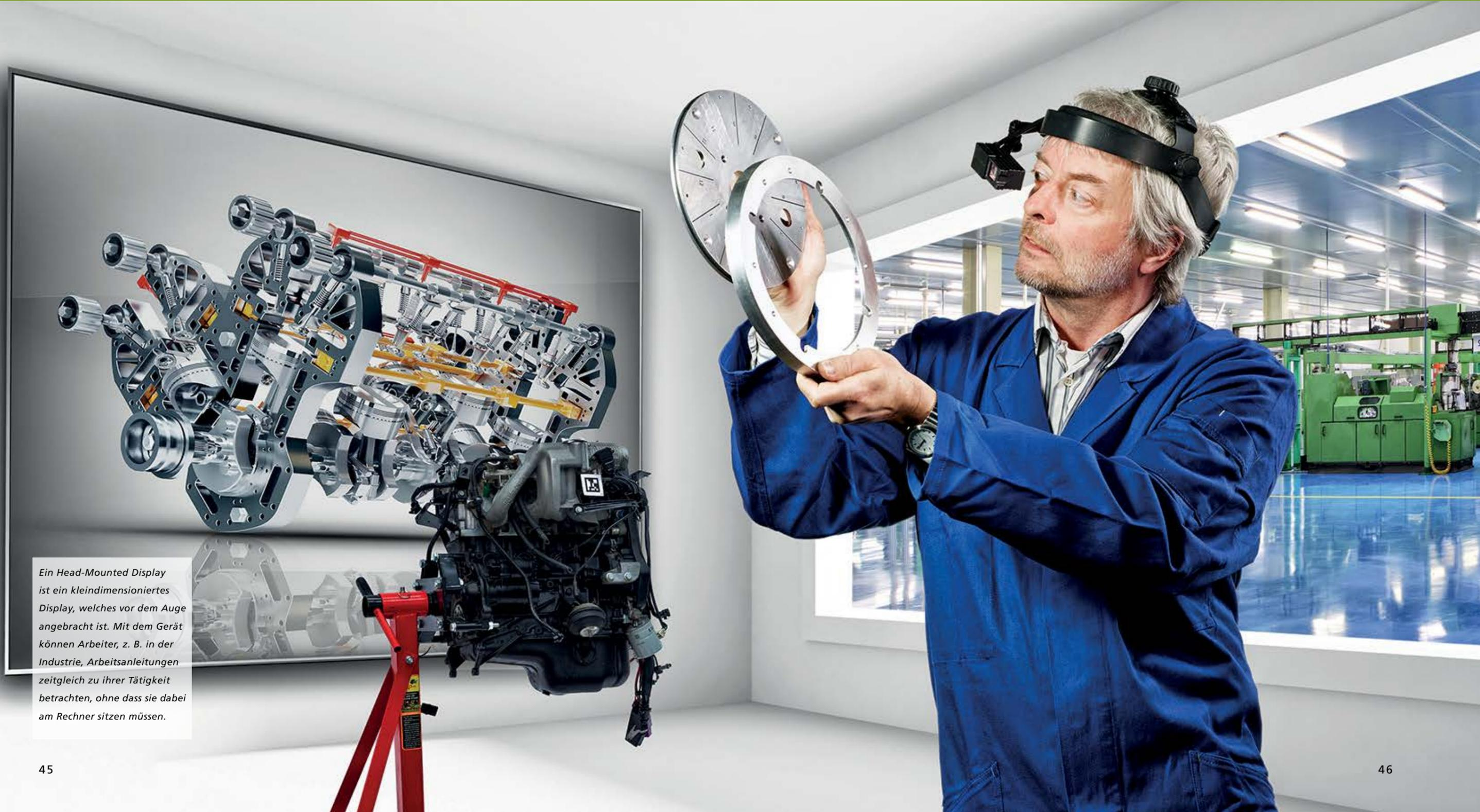
*Ein Head-Mounted Display ist ein kleindimensioniertes Display, welches vor dem Auge angebracht ist. Mit dem Gerät können Arbeiter, z. B. in der Industrie, Arbeitsanleitungen zeitgleich zu ihrer Tätigkeit betrachten, ohne dass sie dabei am Rechner sitzen müssen.*
