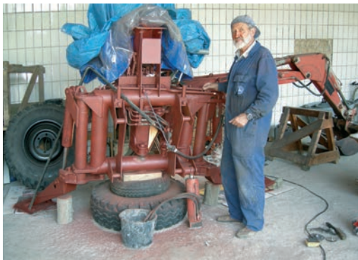
Abb. 12 Bagger mit „Schaeff“-Hydraulik-System.
