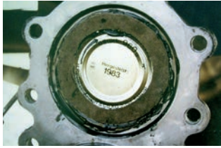
Abb. 5 Der Deckel einer Würstchendose von 1983 zur Abdichtung des Nebengetriebes.
