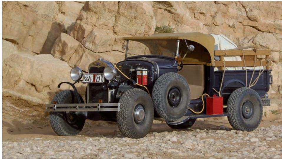
Die ersten Meter mit dem alten Fahrzeug auf losem Untergrund in Tunesien waren sehr ungewohnt. Das anfängliche Hüpfen des Autos konnte durch Luftablassen aus den großen Ballonreifen fast komplett aufgehoben werden. Die nun mit nur 0,8 bar Luftdruck gefahrenen Reifen erforderten während der Fahrt für jede Richtungsänderung einen beherzten Griff ins Lenkrad.
