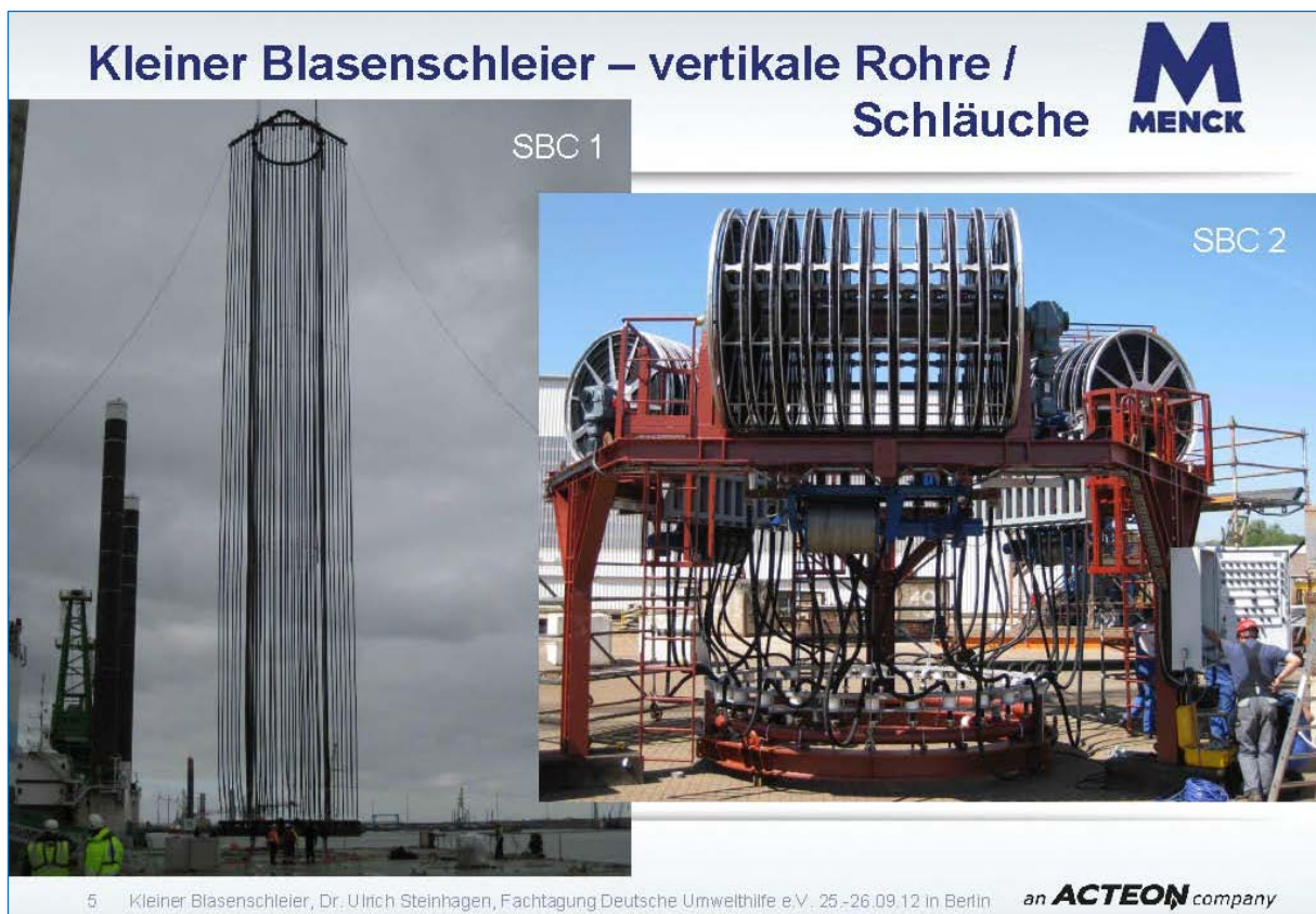
Abb. 11: Kleiner Blasenschleier – vertikale Rohre/Schläuche (STEINHAGEN 2012)
