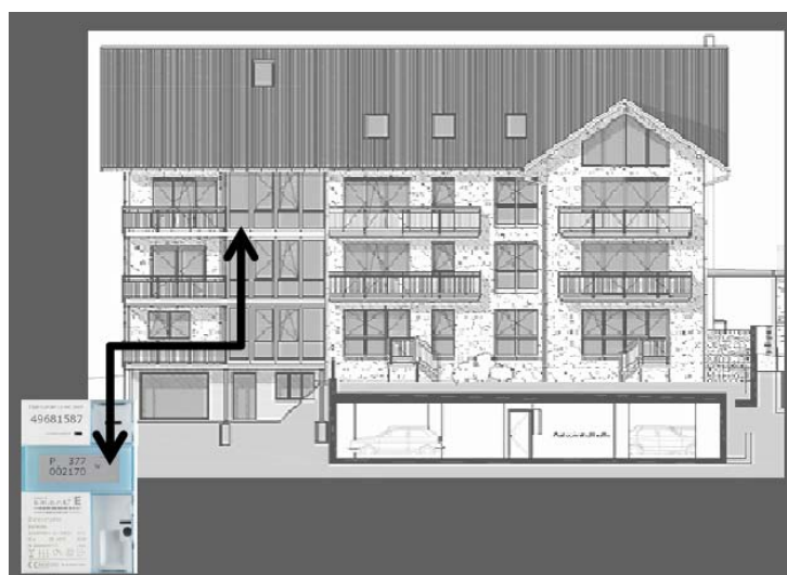
Bild 39: Darstellung der Test-Powerline-Verbindung im Gebäude
