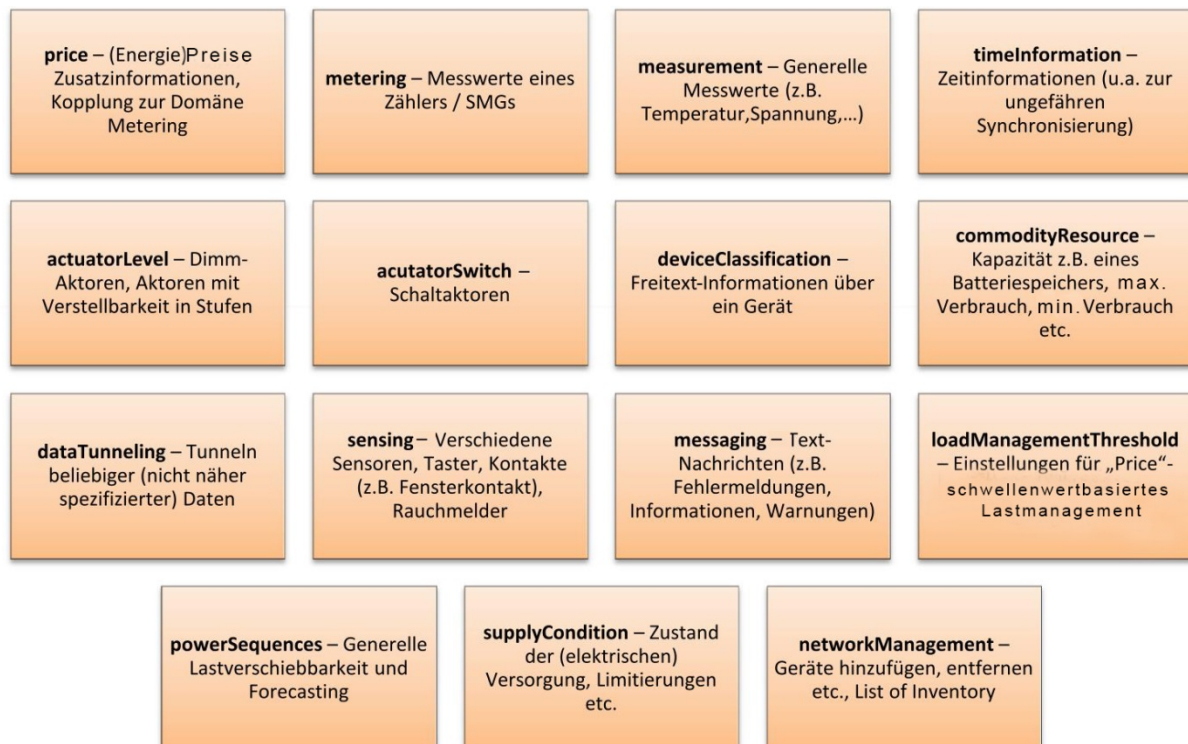
Bild 67: Im aktuellen EEBus V1.0 realisierte Domänen
