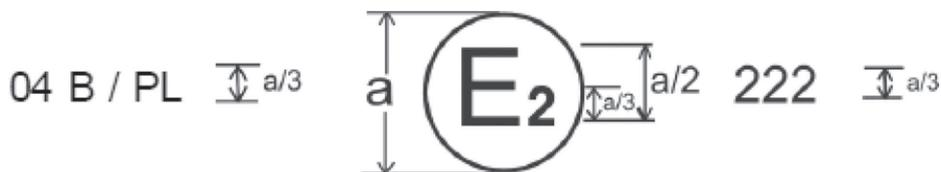
Aus den Abbildungen 2a und 2b geht hervor, dass die Einrichtung ein Nebelscheinwerfer mit einer Kunststoff-Abschlussscheibe ist, der in Frankreich (E2) unter der Nummer 222 nach der Regelung Nr. 19 genehmigt worden ist und nicht gleichzeitig mit einer anderen Leuchte, mit der er ineinandergebaut sein kann, eingeschaltet werden kann.
