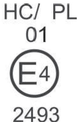
Kennzeichnung eines Scheinwerfers mit einer Kunststoff-Abschluss Scheibe, der den Vorschriften dieser Regelung wie folgt entspricht:
