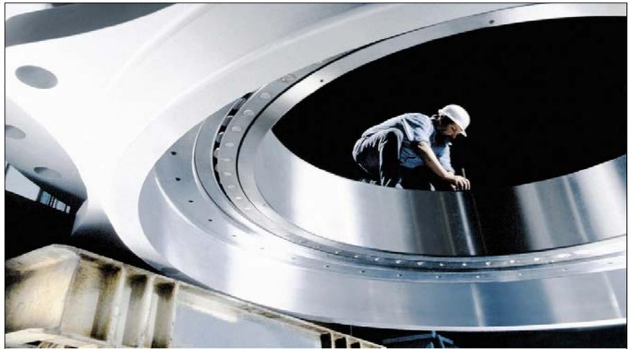
球面滚子轴承的组装 | Montage eines Pendelrollenlagers
