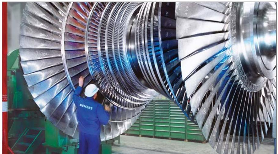
蒸汽涡轮发动机 | Dampfturbine
