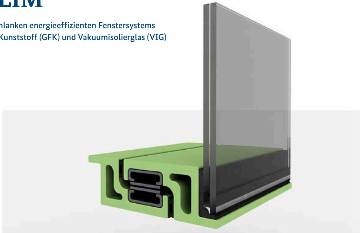
Moderne Wärmeschutzfenster mit Dreifachverglasungen (Passivhausfenster) bieten niedrige U-Werte, erkaufen dies aber mit hohem Eigengewicht. Dies kann etwa den Einbau in Altbauten erschweren. Auch sind zum Tragen der drei Scheiben mit Kunststoffrahmen breite Profile erforderlich, was die Gestaltung der Hausfassade beeinträchtigt. ULTRASLIM soll hier Abhilfe schaffen durch Kombination schlanker Rahmen aus GFK mit neuartigen dünnen VIG-Verglasungen.
