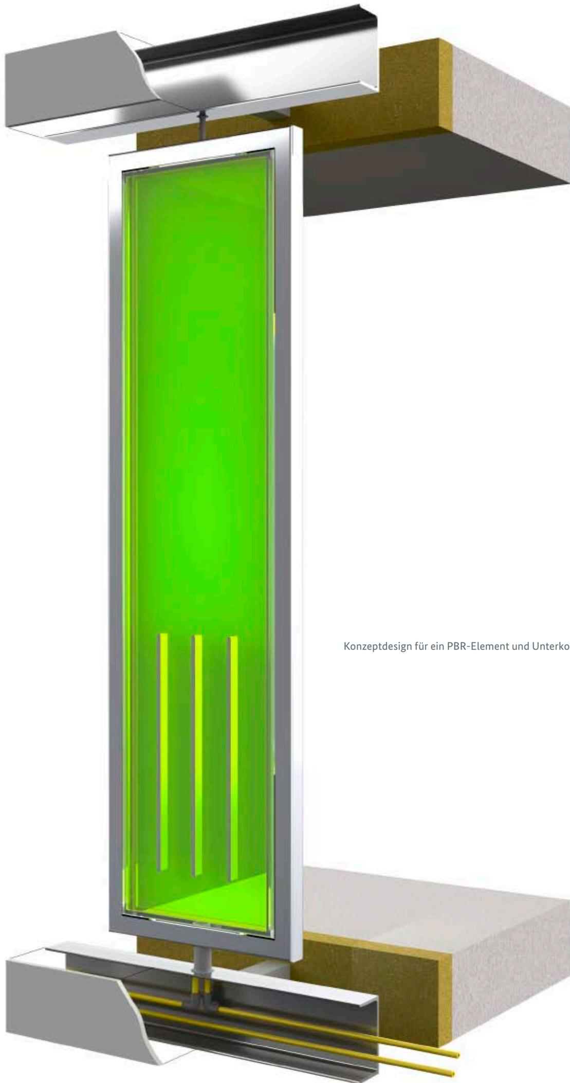
Konzeptdesign für ein PBR-Element und Unterkonstruktion
