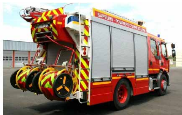
BILD 6.8 Löschfahrzeug auf Renault Midlum mit serienmäßiger Doppelkabine und mit korrekter Kontur- und Heckwarnmarkierung gem. ECE und DIN 14502-3:2009-02 "Feuerwehrfahrzeuge - Teil 3: Farbgebung und besondere Kennzeichnungen"
