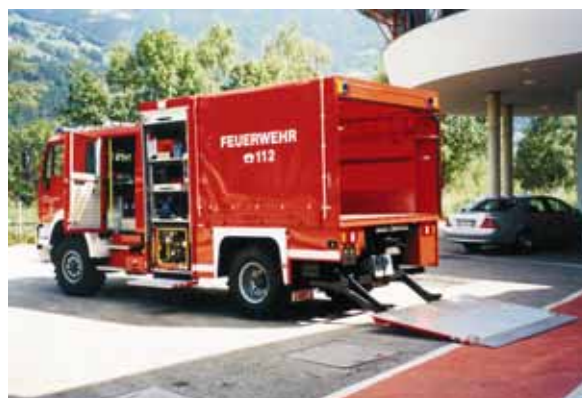
BILD A6.11 Der "VLkw" der FF Agatharied/BY zeigt bereits wesentliche Merkmale des GW-L2, hat allerdings eine Gruppenkabine, die mit 4 PA ausgestattet ist [Fotos: Fa. EMPL, A-6272 Kaltenbach], weitere Informationen unter http://www.agatharied.de/Feuerwehr/ und www.empl.at
