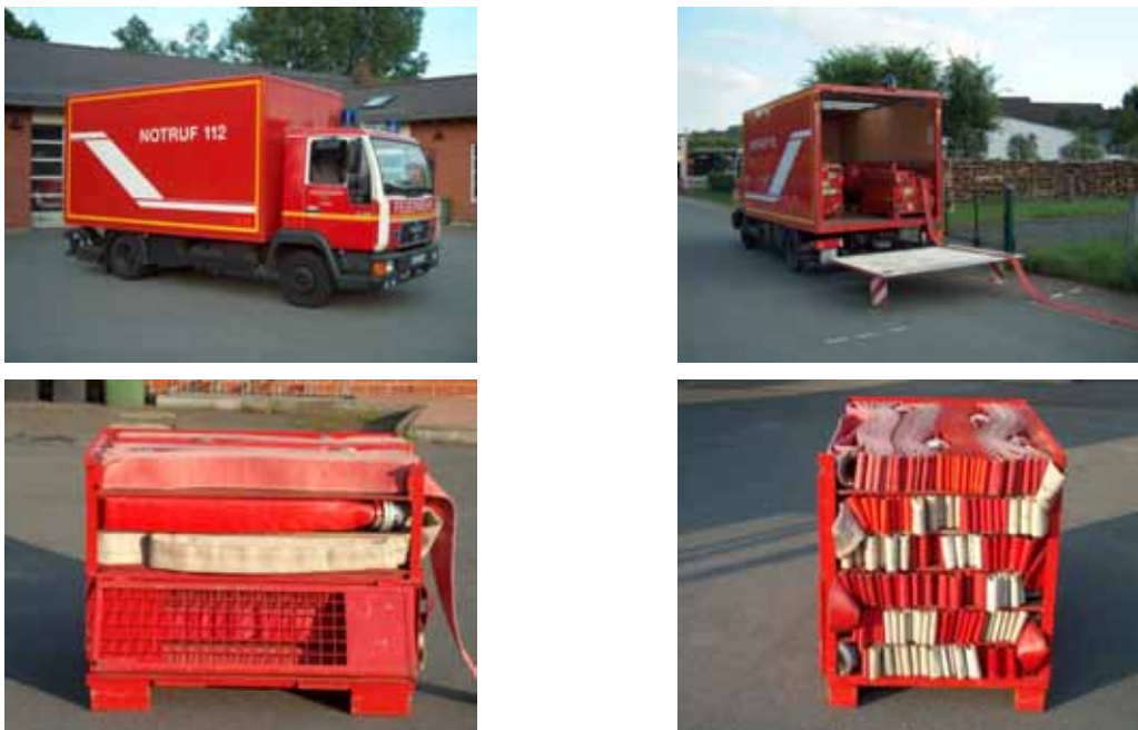
BILD A6.7 GW-N der FF Fuldatal mit B-Schläuchen in Buchten in Gitterboxen [Stefan Finger, Fuldatal]
