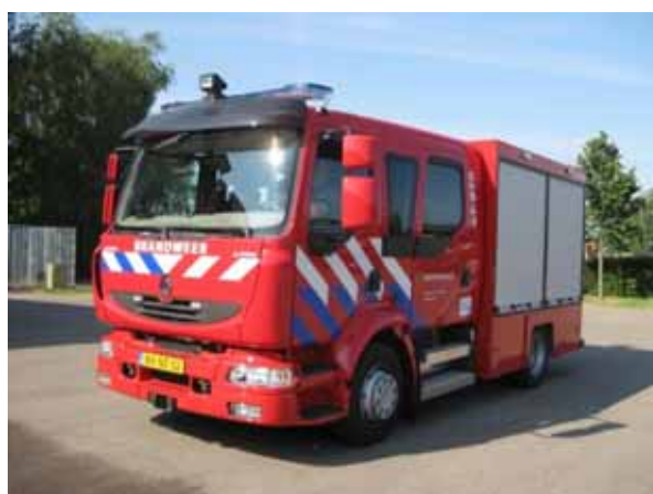
BILD 6.7 Löschfahrzeug auf Renault Midlum mit serienmäßiger Doppelkabine (mit insgesamt 8 PA-Sitzen der Fa. H. O. Bostrom)
