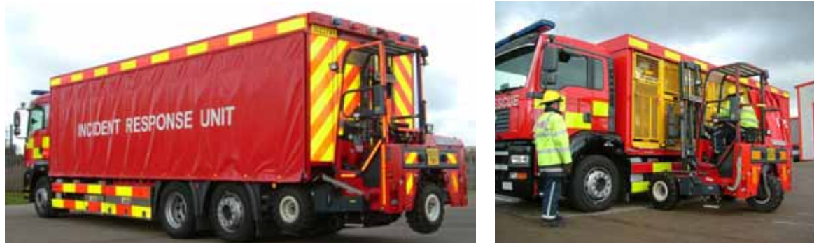
BILD A6.4 GW-N "XXL" einer brit. Feuerwehr mit Gitterpalettensystem und Mitnahmestapler [Werkfotos MOFFETT-KOOI]
