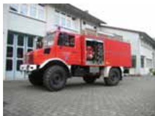
BILD A6.2 SW 1000 in Sonderausführung mit TS auf geländegängigem Fahrgestell [Christian Keller, Roland Bonath]
