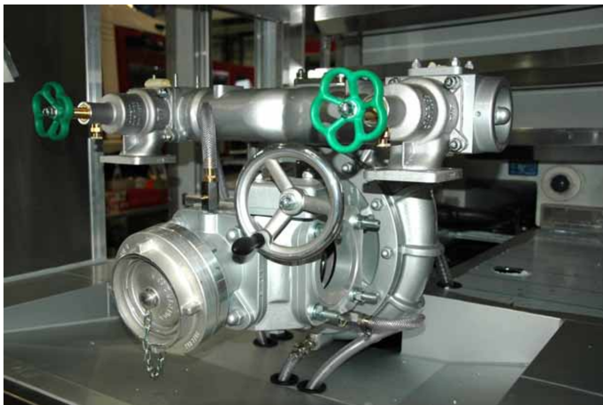
BILD 6.4 Auch bei StLF 10/xx verwendet der Aufbauhersteller EMPL Deutschland grundsätzlich die Pumpe NP3000 der Fa. Jöhstadt
