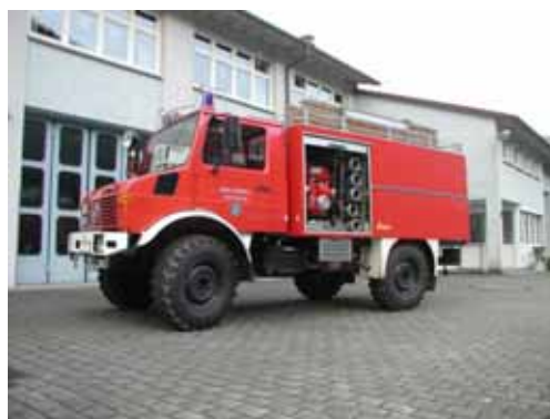
BILD A6.6 Abbildung 5: GW-N mit fest eingebauter Beleuchtung und B-Schläuchen in Rollcontainern [Ingo Horn]
