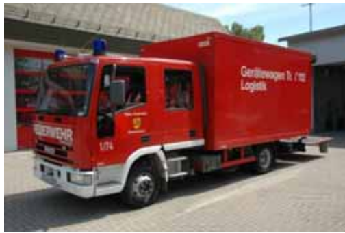
BILD 6.9 Fahrzeuge auf Iveco EuroCargo mit serienmäßiger Staffelkabine, rechts "New Face"
