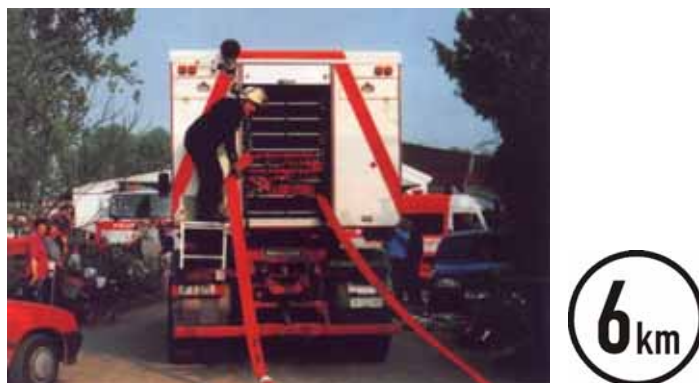
BILD A6.20 Einsatz eines Wechselladerfahrzeugs mit AB-Schlauch, beachte den Standplatz der Einsatzkraft (Quelle: [Matthias Schmidt, Feuerwehr Frankfurt a. M.]
