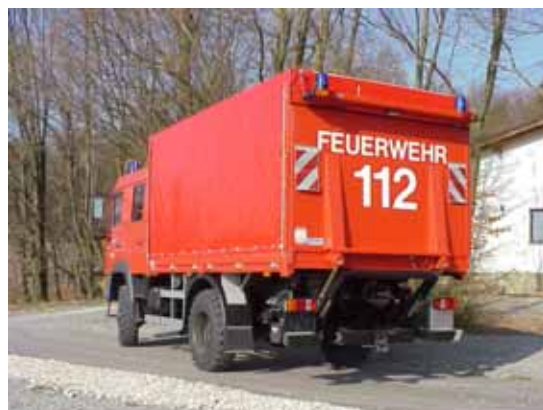
BILD A6.10 Mehrzwecktransportfahrzeug mit Ladebordwand MZF nach Technischer Richtlinie Nr. 5 (Rheinland-Pfalz) [Werksbild HENSEL Fahrzeugbau GmbH & Co. KG; 97295 Waldbrunn]
