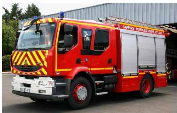
BILD 6.8 Löschfahrzeug auf Renault Midlum mit serienmäßiger Doppelkabine und mit korrekter Kontur- und Heckwarnmarkierung gem. ECE und DIN 14502-3:2009-02 "Feuerwehrfahrzeuge - Teil 3: Farbgebung und besondere Kennzeichnungen"
