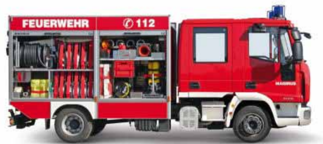
BILD 6.9 Fahrzeuge auf Iveco EuroCargo mit serienmäßiger Staffelkabine, rechts "New Face"
