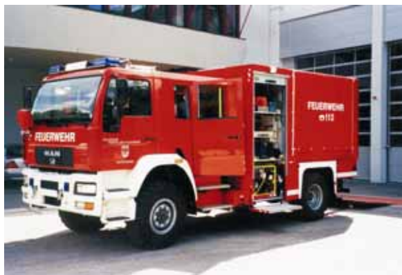
BILD A6.11 Der "VLkw" der FF Agatharied/BY zeigt bereits wesentliche Merkmale des GW-L2, hat allerdings eine Gruppenkabine, die mit 4 PA ausgestattet ist [Fotos: Fa. EMPL, A-6272 Kaltenbach], weitere Informationen unter http://www.agatharied.de/Feuerwehr/ und www.empl.at
