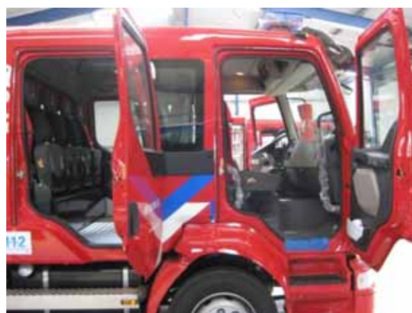
BILD 6.7 Löschfahrzeug auf Renault Midlum mit serienmäßiger Doppelkabine (mit insgesamt 8 PA-Sitzen der Fa. H. O. Bostrom)
