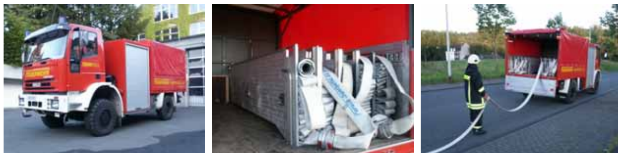
BILD A6.3 6-Personen-Schlauchtragekörbe auf der Ladefläche eines SW 2000-Tr (KatS) [Eric Tribble]
