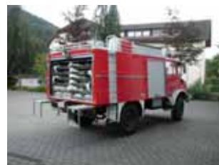
BILD A6.2 SW 1000 in Sonderausführung mit TS auf geländegängigem Fahrgestell [Christian Keller, Roland Bonath]
