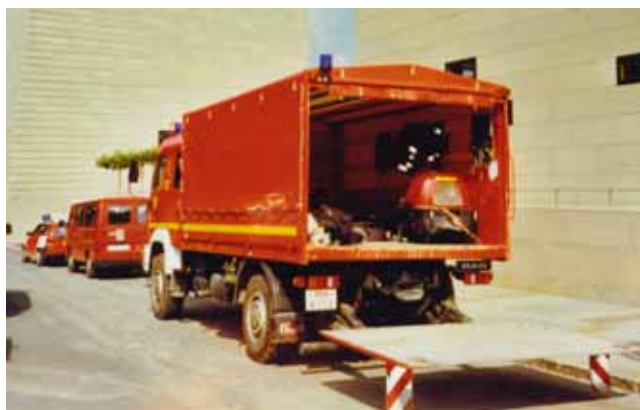
BILD A6.9 Auch der Dekon-P hat sich als flexibler Mannschafts- und Geräteträger bewährt, hier beim Fluteinsatz in Dresden, August 2002. Fahren mit abgesenkter Ladebordwand ist aber schlecht möglich, wie dieses Bild zeigt. [de Vries]
