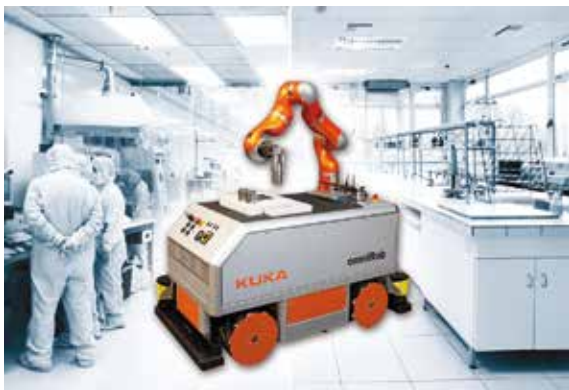
Das Projekt ISABEL entwickelt ein mobiles Servicerobotersystem für die Materiallogistik.
