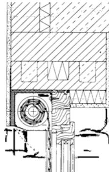
Vertikalschnitt: Rollladenanschluss mit Fertigsturz
