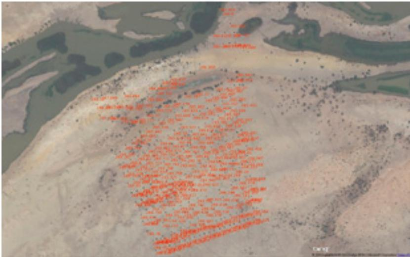
La levée topo du PIV de Saka intégrée dans le SIG en utilisant le logiciel libre Qgis. Le fond est une image "Bing Aerial" et permet d'apprécier certaines caractéristiques du terrain.
