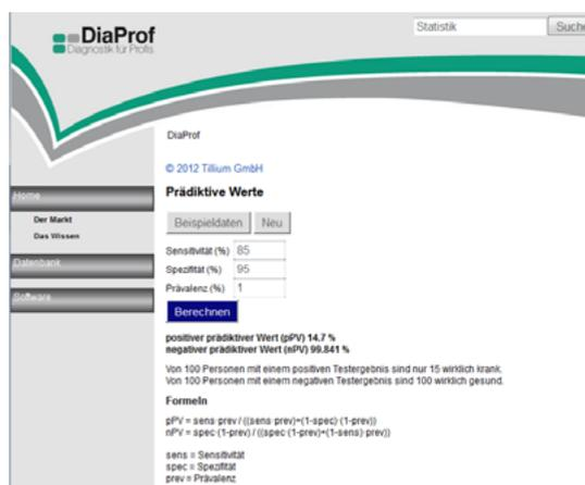
Abb. 1: Screenshot eines Internetprogramms zur Berechnung statistischer Kennzahlen für die Güte eines diagnostischen Tests ([www.diaprof.org](http://www.diaprof.org)). Auch ein guter diagnostischer Test mit 85 Prozent Sensitivität und 95 Prozent Spezifität liefert bei 1 Prozent Prävalenz nur 15 Prozent richtig positive und 85 Prozent falsch positive Ergebnisse.
