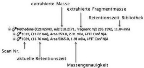
Abb. 4 Ergebnis der Bibliothekssuche: ein Hit, hier Methadon, wird von der Software so angegeben, dass der Substanzname, die Summenformel, die extrahierte Masse, die Retentionszeit aus der Bibliothek, die Scan-Nummer im Probenlauf, die gefundene Retentionszeit, die Massenabweichung und das zugehörige Fragmentation dargestellt werden.
