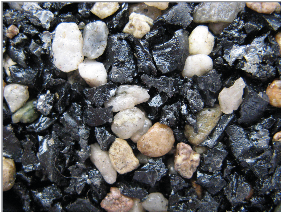
Abb. 2. Gebundene elastische Tragschicht (eine Mischung aus mineralischen Aggregaten und Altreifengranulat gebunden mit Polyurethan) Foto: Bundesanstalt für Materialprüfung
