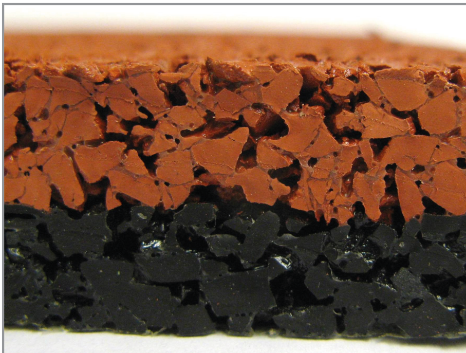
Abb. 1. Schnittfläche eines Sportbelages auf Kunststoffbasis (unten Altreifengranulat gebunden mit Polyurethan, oben Schüttbeschichtung mit Ethylen-Propylen-Dien-Kautschuk) Foto: Bundesanstalt für Materialprüfung
