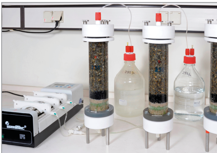
Abb. 3. Säulenversuche mit einem verfüllten Kunstrasensystem einschließlich der gebundenen elastischen Tragschicht mit Altreifengranulat und der ungebundenen Tragschicht
