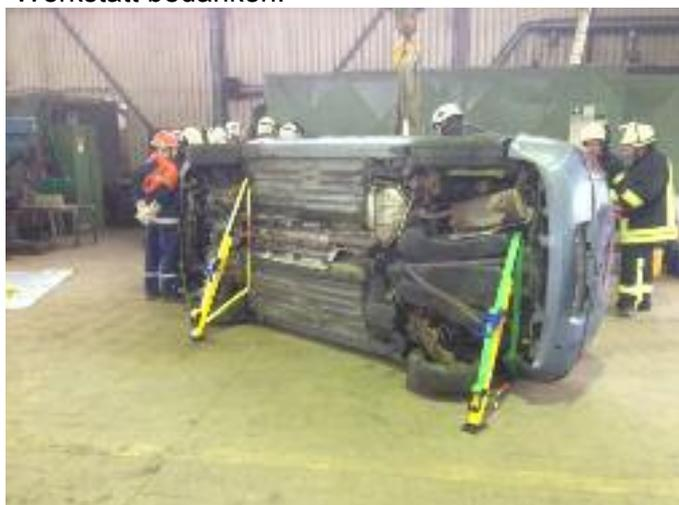
Bild: Stab-Fast-System im Einsatz
