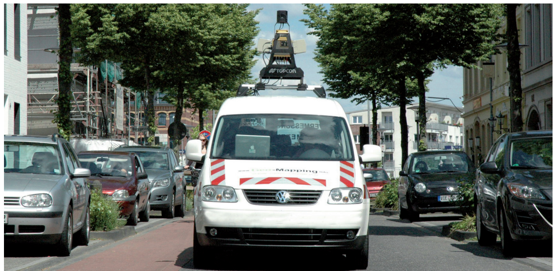
Hier werden die Daten für das Straßenbeleuchtungsnetz erfasst
