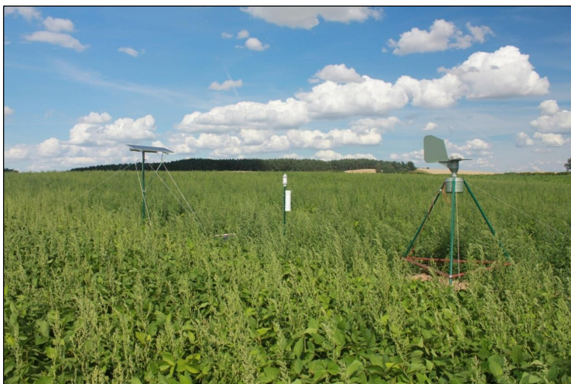
Abb. 75: Messstandort AN7 mit Pollenmonitor Burkard im Solarbetrieb und Passivsampler PMF im Sojafeld zwischen den Maisfeldern A und B (19.7.2011). (Bild: Hofmann)
