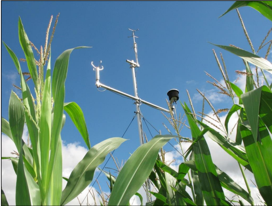
Abb. 41: Messeinrichtungen zur Meteorologie am Mast. 3D-Ultraschall-Anemometer (USA) an der Spitze (6,85 m), 2-D USA, Feuchte- und Temperaturmesseinheit (5,65 m). (Grafik: Wittich)
