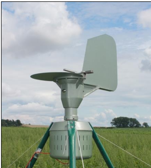
Abb. 27: Die klassische Burkard-Falle (Burkard Manufacturing Ltd., Hirst-Prinzip) am Standort AN5 in 180 m Entfernung vom Feldrand. Der Volumenstrom beträgt 10 l/min, die Umdrehungszeit der Trommel ist mechanisch eingestellt auf 7 Tage (2 mm/h). Stromanschluss: 230 V (klassisch) oder 12 V (Typ II) über Batterie/Solarpanel/Netzteil. Der horizontal gerichtete Einlass (14 mm x 2 mm) wird über eine Windfahne in den Wind ausgerichtet, die Einlasshöhe beträgt hier 1,8 m. Der Einsatz des Gerätes zur Erfassung von Maispollen ist auf Grund der Gerätekonstruktion nur abseits der Felder sinnvoll. (Bild: Hofmann)
