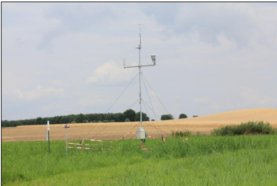
Abb. 40: Messplatz AN1 außerhalb des Feldes 50 m westlich vom Maisfeldrand im Feuchtgebiet. Messstation mit 3D-Ultraschall-Anemometer (USA) an der Spitze (6,85 m), 2-D USA, Feuchte- und Temperaturmesseinheit, Datenlogger. (Grafik: Wittich)
