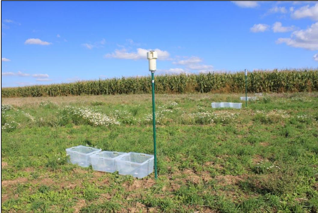
Abb. 161: Streufallen (OKT Multi Box XXL, 0,22 m 2 : 52 cm x 43 cm x 26 cm). Rechts daneben der Passivsammler Sigma-2. Transsekt A mit Blick auf Feldrand, Vordergrund Standort in 20 m Entfernung vom Feldrand. (Bild: Hofmann)
