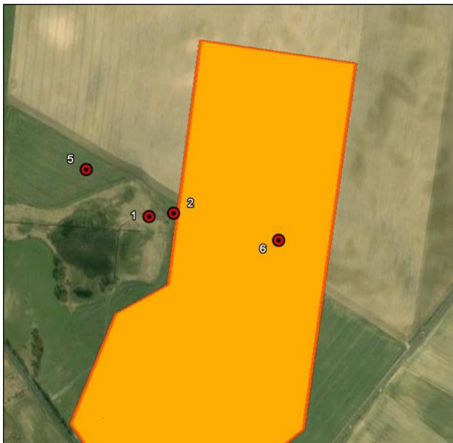
Abb. 24: Standorte der Pollenmonitore in 2010; AN6: Im Feld, Pollenmonitor PMO und DWD, AN2: 10 m vom Feldrand, Pollenmonitor PMO, AN1: 50 m vom Feldrand, Pollenmonitor DWD, AN5: 180 m vom Feldrand, Pollenmonitor Burkard.
