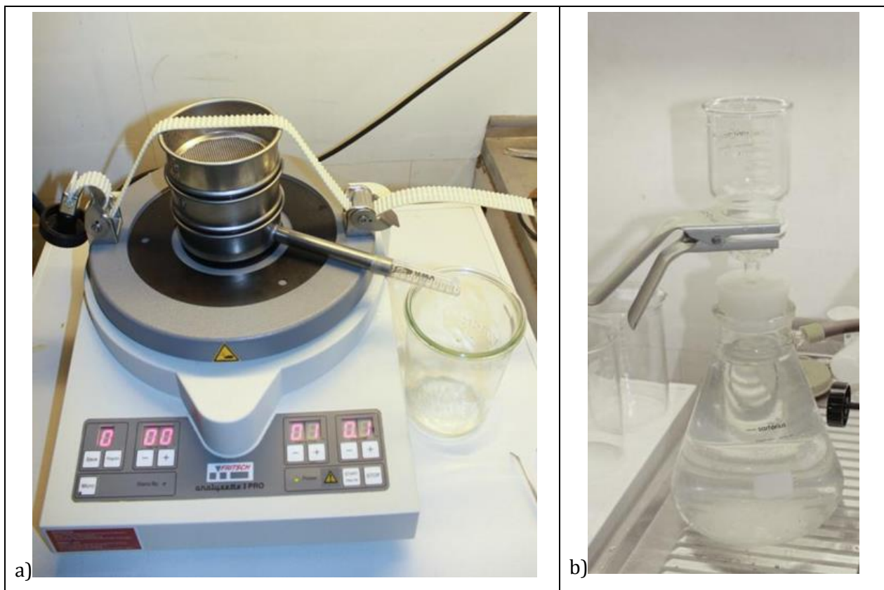
Abb. 170: a) Siebmaschine (Analysette Pro, Fritsch GmbH) mit Siebkaskade aus Analysesieben (100 mm Durchmesser) mit Maschenweiten 1 mm (oben), 63 \mu\text{m} (mittig) und Siebpfanne mit seitlichem Auslauf zum Auffangen des Durchlaufgutes mit Partikeln < 63 \mu\text{m} in 1.000 ml - Becherglas; b) Abscheidung der Partikelfractionen mittels Vakuumfiltration (Sartorius) auf 12 \mu\text{m} Membranfilter zur anschließenden Trocknung und Wiegung. (Bilder: Hofmann)
