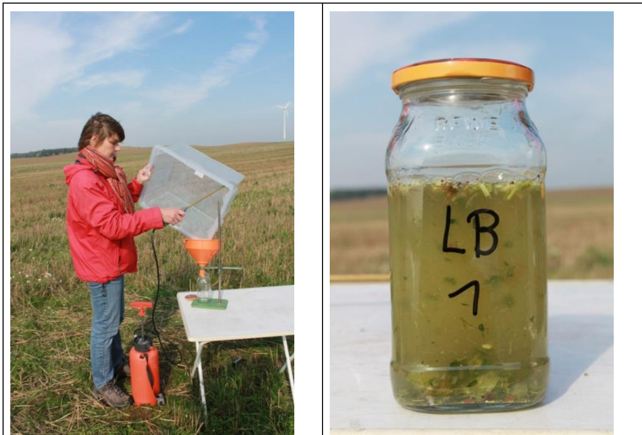
Abb. 169: Überführung der Streuprobe aus dem Sammelgefäß im Gelände in ein verschließbares Glasgefäß mittels Spritzflasche; rechts Beispiel einer Streuprobe aus 1 m Entfernung. (Bilder: Hofmann)
