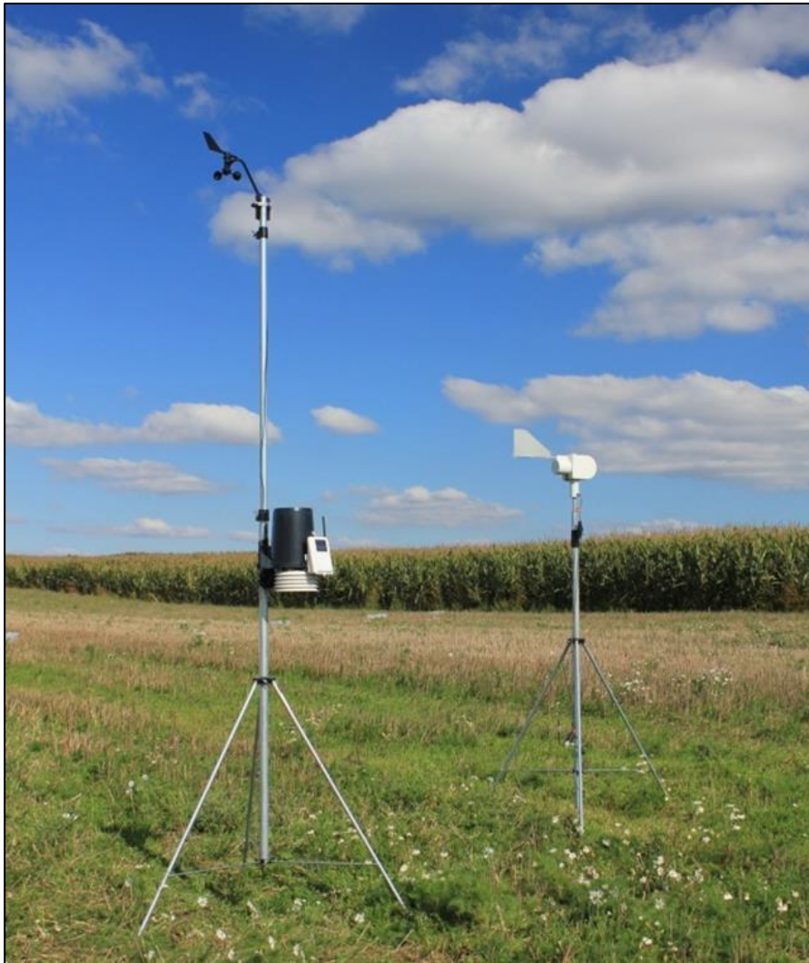
Abb. 165: Mobile Meteorologie-Messstation mit Funkdisplay und Datenlogger (Davis Vantage Pro II), Windmesser (Richtung und Geschwindigkeit) in 3 m Höhe, Temperatur-, Feuchte- und Niederschlagssensor in 1,5 m; rechts volumetrischer Aerosolsammler Sporewatch (1,8 m Höhe, 10 l/min; Burkard Scientific Ltd.) (Bild: Hofmann)
