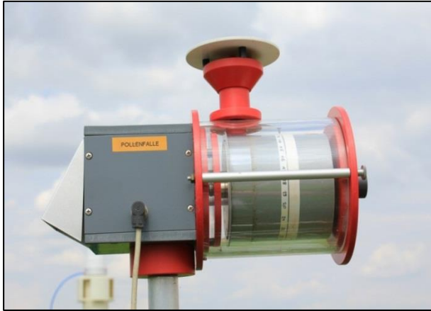
Abb. 26: Pollenmonitor des DWD. Aktivgerät mit Rundum-Einlass und Impaktion auf Trommel mit Klebefilm, ebenfalls für die Erfassung von Maispollen auch im Nahbereich ausgelegt. Der von einem Lüfter erzeugte Volumenstrom beträgt 10 l/min (Low-Volume) analog zur Hirst-Falle (Burkard, Lanzoni), die Umdrehungszeit der Trommel 7 Tage (2 mm/h), die Schlitzweite des Impaktors 4 x 16 mm. Stromanschluss: 230 V. Die handliche Falle kann vom Verbrauch her auch über 12 V-Batterie bzw. über Solarpanel mit Akku betrieben werden. (Bild: Hofmann)
