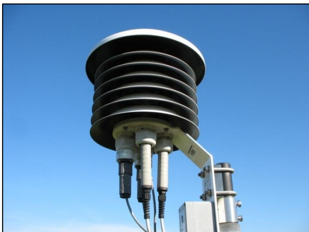
Abb. 44: Temperatur- und Feuchtesensor mit Strahlungsschutz. (Grafik: Wittich)
