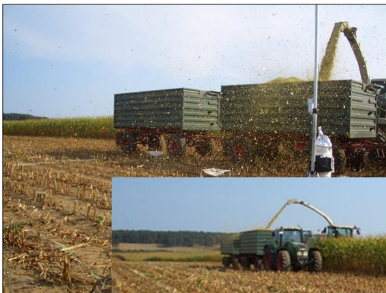
Abb. 151: Streufallbelastung in Abwindlage beim Passieren der Erntemaschinen, Maisfeldrand ca. 18 m entfernt. (Bilder: Hofmann)
