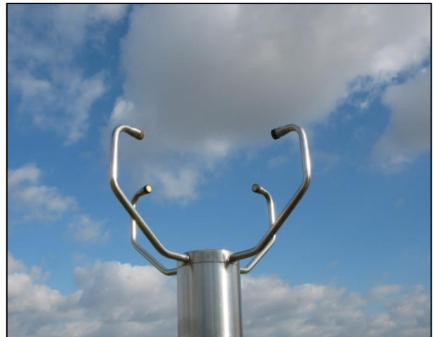
Abb. 43: Zweidimensionales Ultraschall-Anemometer. (Grafik: Wittich)
