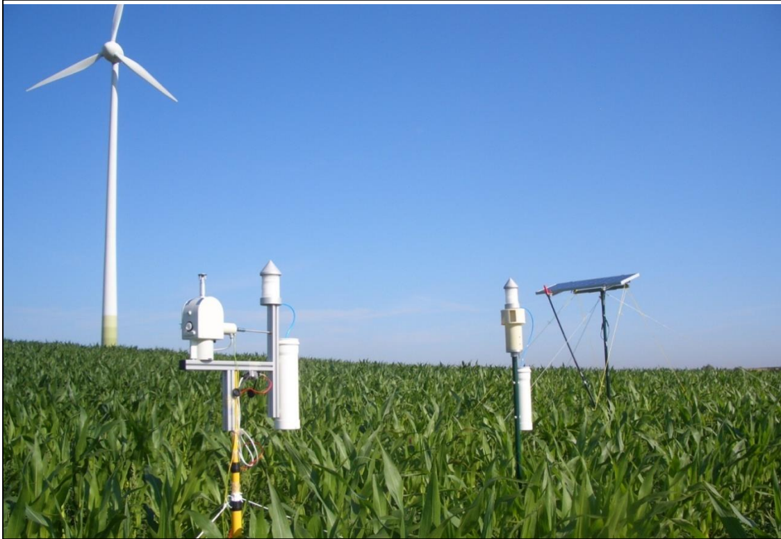
Abb. 72: Pollenmonitor PMO-LV Solar mit Passivsammler PMF (AN1) und PMF/Sigma-2 (AN2) am Standort AN1 im Maisfeld A (Zeitpunkt der Installation 7.7.2011 vor Blühbeginn). (Bild: Hofmann)
