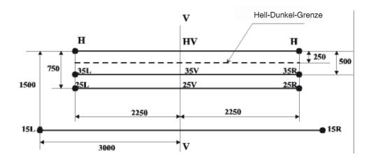
(Abmessungen in mm bei 25 m Entfernung)
