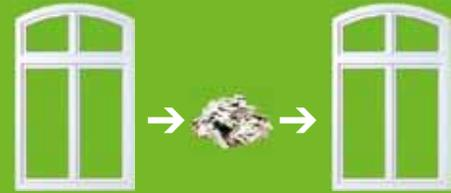
In Kunststofffenstern steckt PVC. Ein Werkstoff mit hervorragenden Materialeigenschaften wie Langlebigkeit oder Witterungsbeständigkeit. Und mit einer positiven Ökobilanz. Denn Kunststofffenster können wiederverwertet werden. Beim Recyceln wird sortenreines PVC zurückgewonnen und der Fensterprofil-Produktion erneut zugeführt. Dafür sorgen professionelle Recyclingtechnik. Und Ihre Unterstützung. [www.rewindo.de/Infoline](http://www.rewindo.de/Infoline) 0228. 921 28 30
