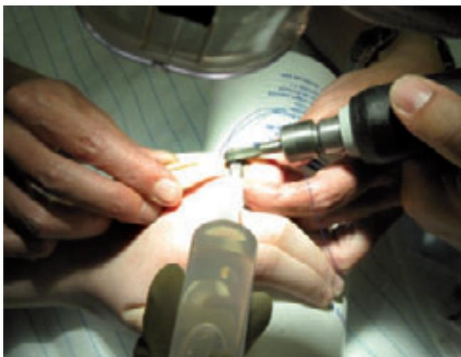
Bild (26) Mit einer Türschlossfräse durchtrennten Einsatzkräfte einen Fingerring (BfK)
