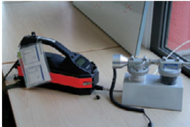
Bild (77) Das GDA (links) an einer Spülstation beim Reinigen des Geräts (BFK)
