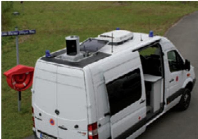
Bild (76) Das Fernerkundungsgerät im Heck des ELW-ATF (BFK)
