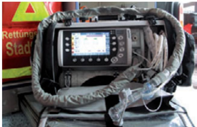
Bild (63) Das Beatmungsgerät Medumat-Transport (BFK)
