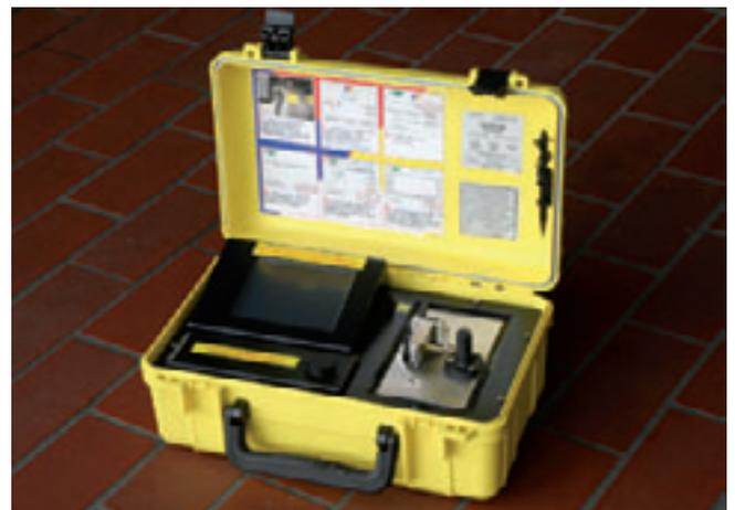
Bild (75) Das Infrarotspektrometer (BFK)
