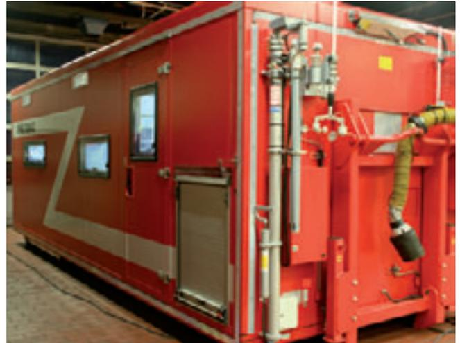
Bild (71) Der Abrollbehälter Analytik ist ein mobiles Labor (BFK)
