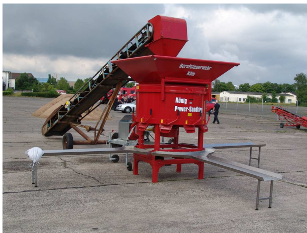
Befüllstation fertig zum Gebrauch
