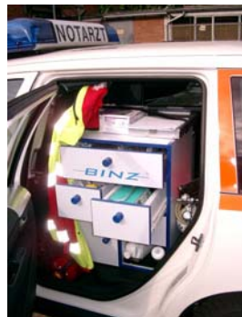
Heckausbau und Seitenschrank links des NEF
