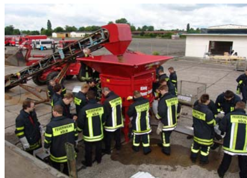
Sandsackfüllmaschine Sand-King im Einsatz
