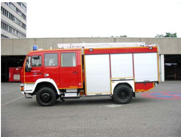
TLF 16/25 MAN Fahrgestell mit Aufbau der Fa. Schlingmann
