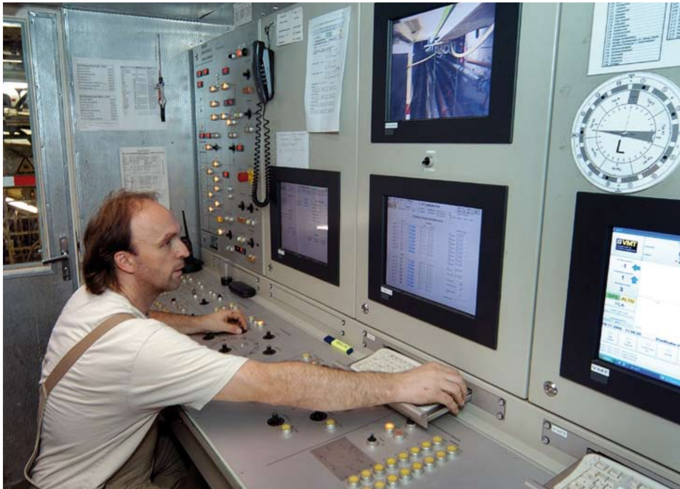
Im Führerstand werden Vortrieb und Förderkreislauf elektronisch überwacht.
