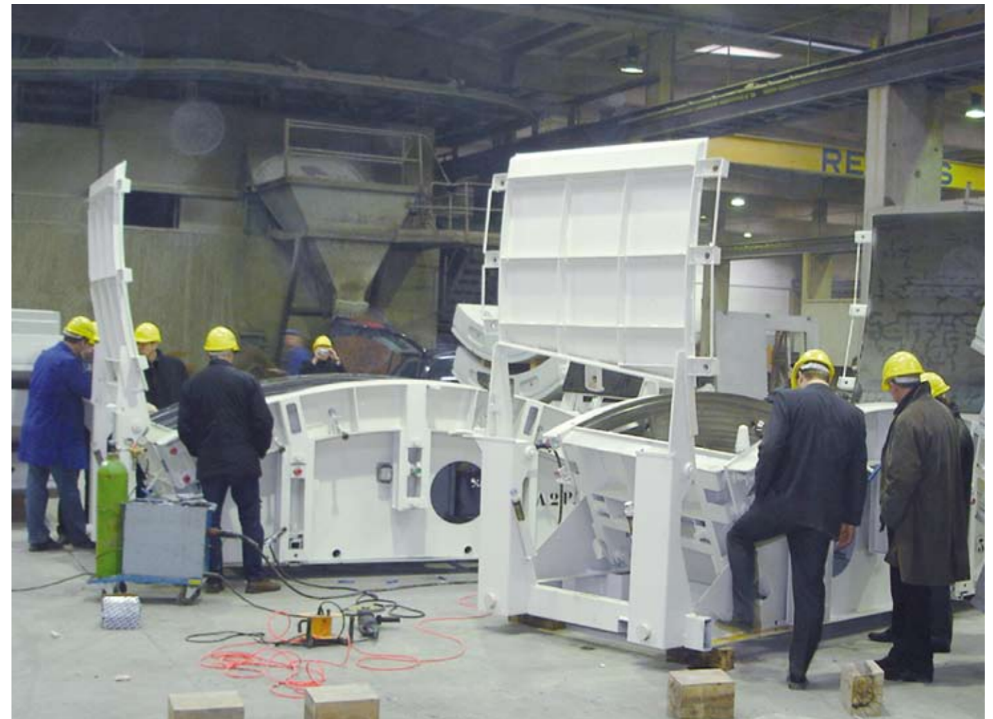
Stählerne Schalung für den Beton.
