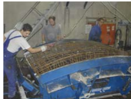
Die Stahlbewehrung verstärkt den Tübbing.
