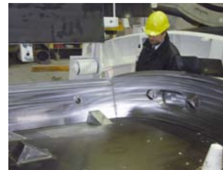
Stählerne Schalung für den Beton.
