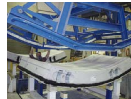
Der fertige Tübbing wiegt mehrere Tonnen.
