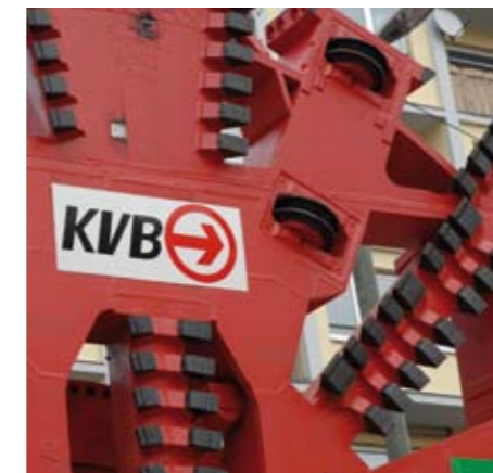
Das Schneidrad baut mit Schälmessern und Rollenmeißeln das Erdreich ab.
