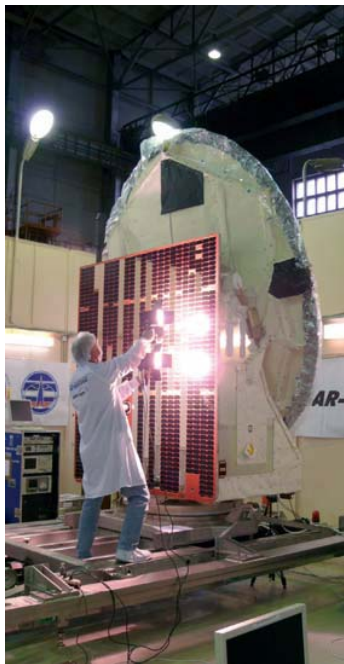
Ein Techniker testet die Leistungsfähigkeit der Solarzellen des SAR-Lupe Satelliten.
