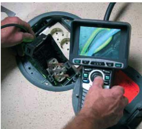
*Endoskopische Untersuchung eines Kabelschachtes im Rahmen der Lauschabwehr: Auf dem Monitor sind die Bilder zu sehen, die das biegsame Rohr mit der Kamera aus dem Innern der Kabelkanäle aufnimmt.*
