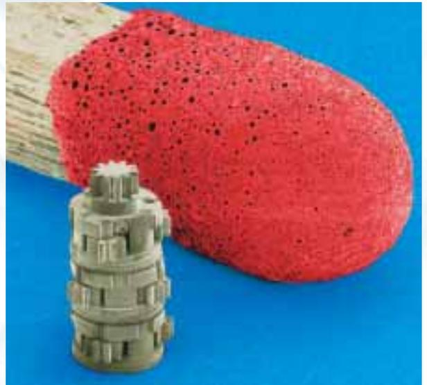
*„Planetengetriebe“ für miniaturisierte Motoren mit hoher Drehzahl. Solche Nanomotoren kommen u.a. in Minidisc-Playern und in der Chirurgie zur Anwendung.*
