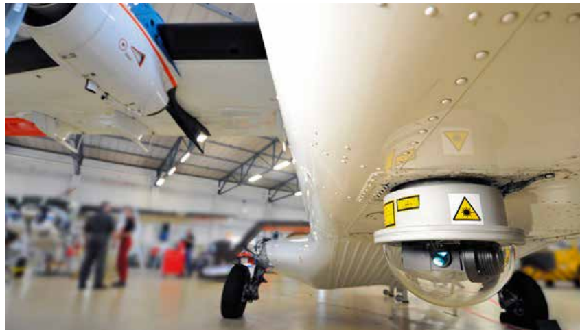
Am Rumpf des DLR-Forschungsflugzeugs Do228-212 ist der Außenanbau des Laserterminals festgeschraubt
