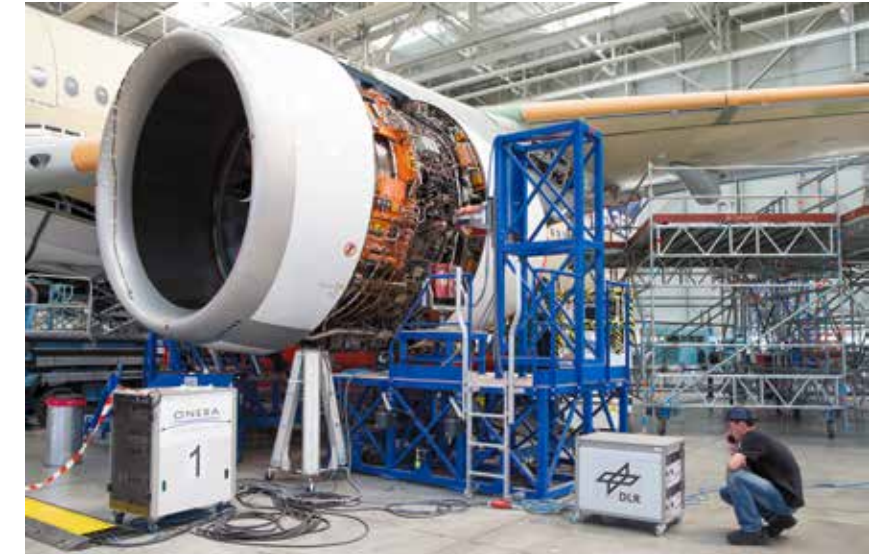
Standschwingungsversuch am Airbus A350 XWB
