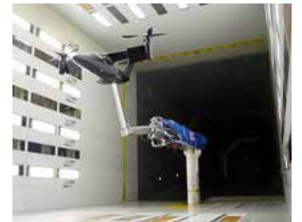
NICETRIP-Windkanalmodell in der 9,5 Meter x 9,5 Meter Messstrecke des DNW LLF
