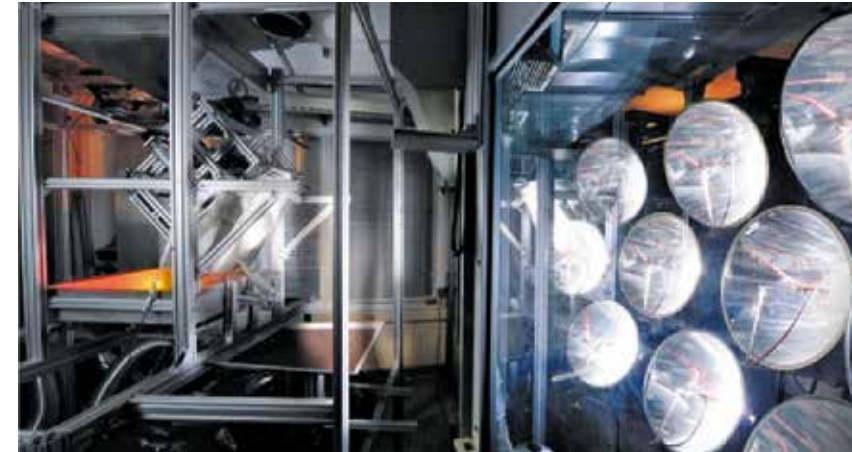
Zentrifugalreceiver beim Test im Hochleistungsstrahler
