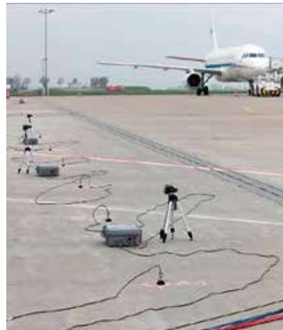
Mikrofonarray und Einzelmikrofone zur Vermessung der Triebwerksströmung
