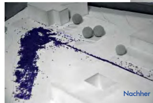
Simulationen durch das Projektteam durchgeführt, deren Ergebnisse einen solch kombinierten Ansatz dezentraler Anlagen fundieren. Die Abbildungen zeigen ein gegenständliches Modell eines Pilotgebiets. Durch die beschriebene Maßnahme kann in diesem Beispiel eine Überflutung eines Gebäudes (vorher) vermieden werden (nachher). Somit kann der lokale Wasserhaushalt nachhaltig gestärkt werden und bei seltenen Starkregen ein robuster Entwässerungsbetrieb aufrecht erhalten werden. ●
