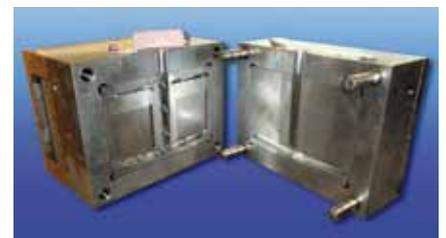
Bild: Neue Versuchskokille für die Kippgießanlage
