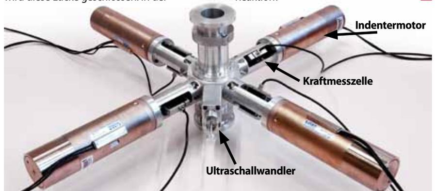
Die Abbildung zeigt die Versuchsanordnung zur Korrelation von Schalleitungs- und mechanischen Eigenschaften. Vier sternförmig angeordnete Indentermotoren mit Kraftmesszellen ermitteln die Kernfestigkeit in Abhängigkeit von der Frequenz der durch Ultraschallwandler erzeugten Signale.
