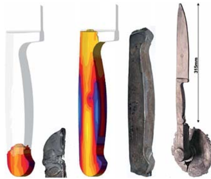
Validierung der MAGMASoft-Simulation durch Stepshots.
