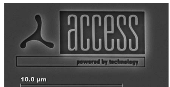
Mit dem Ionenstrahl aus einer polierten Siliziumoberfläche herauspräparierte Schrift. Tiefe ca. zwei tausendstel Millimeter.
