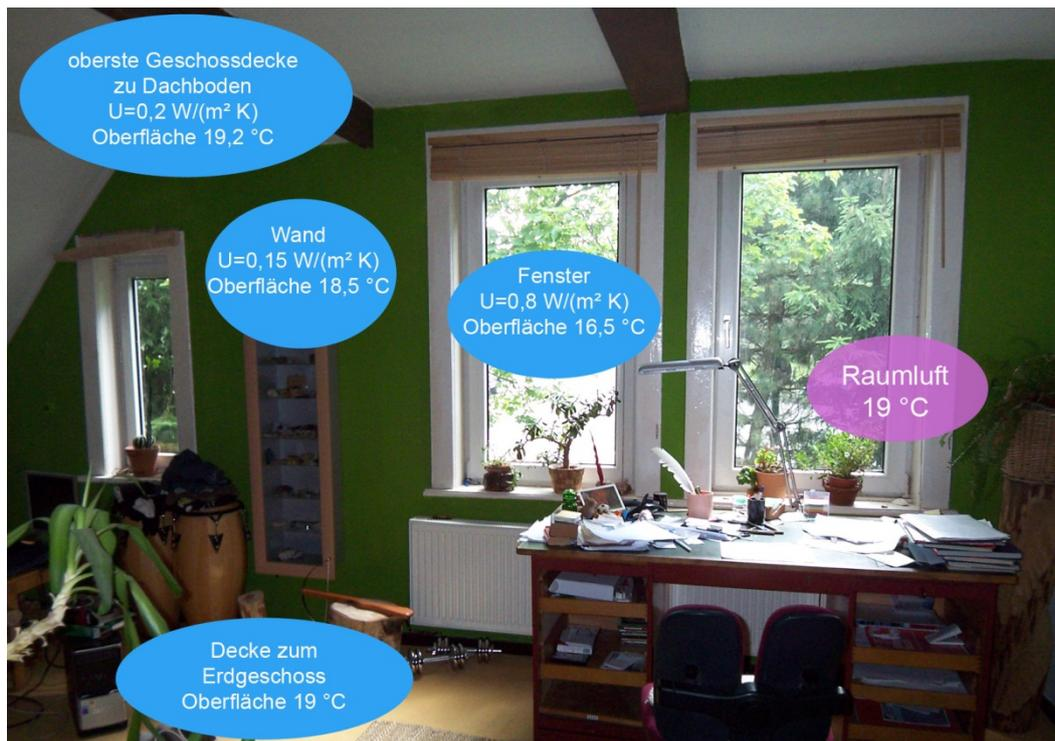
Abb. 4: Nach der Sanierung lässt sich das Gebäude mit deutlich geringerer Temperatur beheizen
